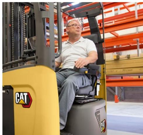
Le travail est précis et sans stress grâce au joystick multifonction et à l'unité de commande *Palm Steering*. Pour une position de conduite confortable, le cariste peut régler la position des accoudoirs et la hauteur du plancher. Il peut aussi incliner le siège à sa convenance pour voir les charges en hauteur sans contrainte.
