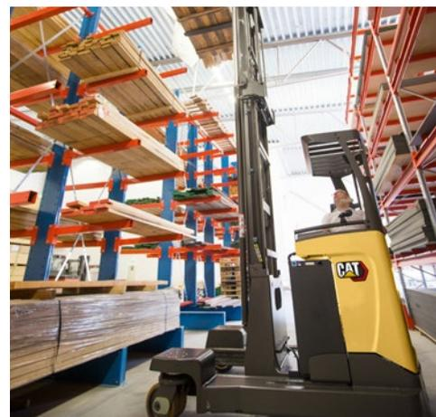
Le réglage automatique de la vitesse de conduite et celle des composants hydrauliques en fonction de l'angle de braquage, de la hauteur de levée et du poids de la charge garantit un fonctionnement sûr, rapide et en douceur. Selon le modèle de mât inclinable employé, le contrôle de stabilité du mât est standard ou optionnel.
