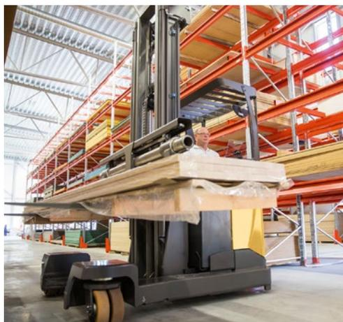
L'écarteur de fourches hydraulique facilite la manutention de palettes normales et de charges nettement plus longues. Combiné à des changements de direction rapides et à la capacité multidirectionnelle du chariot (avant, arrière, gauche et droite), ce système rend les manœuvres aisées dans les allées étroites.
