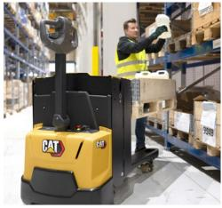
Le NPP20N3E est équipé de fourches élevables (hauteur de 730 mm) qui assurent une position ergonomique pour le chargement et le déchargement des marchandises, avec un minimum d'effort physique.
